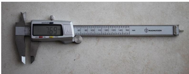
**Figure 13** : Pied à coulisse numérique utilisé pour les mesures.
